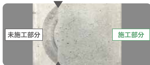
回転式ホイールトラッキング試験 (タイヤ荷重: 70kg 試験時間: 15分 回転数: 105回/分)
